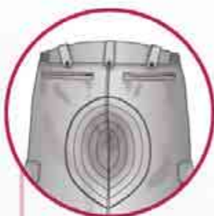
2-REFUERZO EN CULERA Exterior con varios pespuntos
